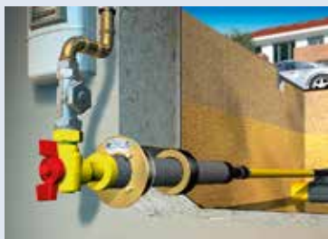
Einsparten-Hauseinführung GERADE Quelle: Fachverband FHRK
