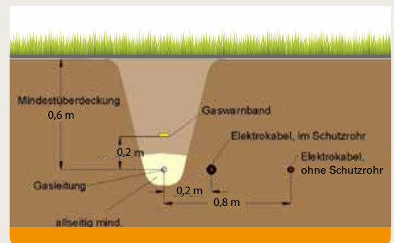
Vermaßter Querschnitt einer erdverlegten Leitung
