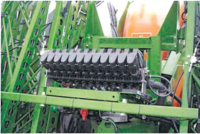
Bild 2: Elektromechanische Abschaltanlage an einer Pflanzenschutzspritze Quelle: https://amazone.de/de-de/produkte-digitale-loesungen/landtechnik/pflanzenschutztechnik/anhaengefeldspritzen/76374-76374 (17.06.2024)
