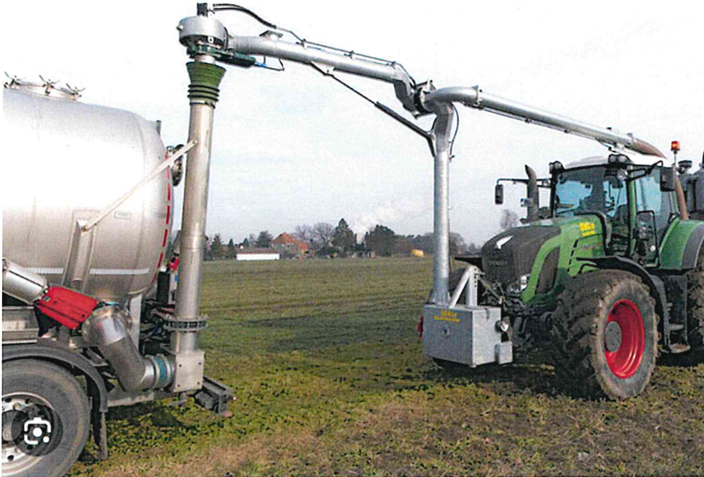
Bild 1: Verlustfreie Übergabe von Gülle aus einem Transportwagen zum Güllewagen mittels Saugleitung Quelle: agrarheute 2017 (12.06.2024)
